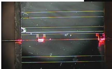
Fig.1. Imagine a cuplajului optic a doua fotodiodi prin intermediul unui ghid de unda
